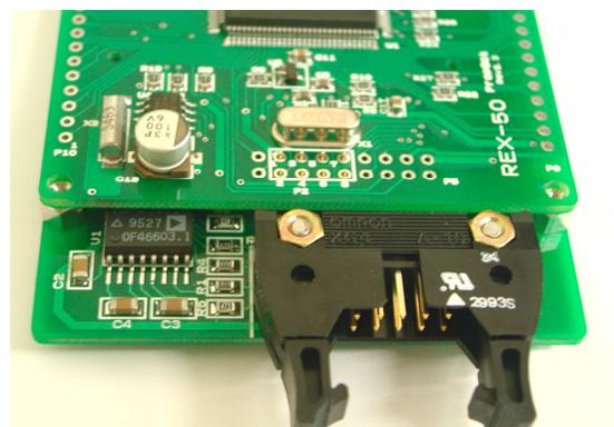
REX50 のネジ孔へネジを挿しこみ、REX50 と RS232C-REX50 を固定します。
